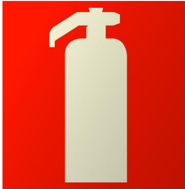
Figura 17 - Placa E-5 de indicação de localização do extintor de incêndio Fonte: IT 15 - Sinalização de Emergência CBMMG.
